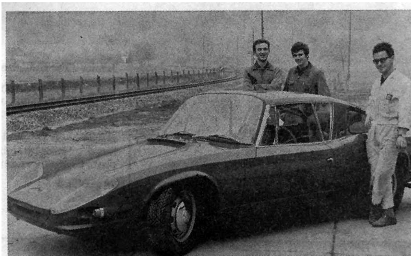
Serienwürdig — Von Georges Filipinetti bestellt, hätte dieses zweite VW-Coupé in einer kleinen Serie hergestellt werden können. Es wiegt 850 kg, wird von einem VW-1600-Motor angetrieben und erreicht 180 km/h.
